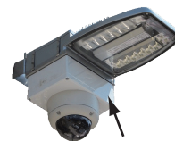
無線 LAN ユニット
